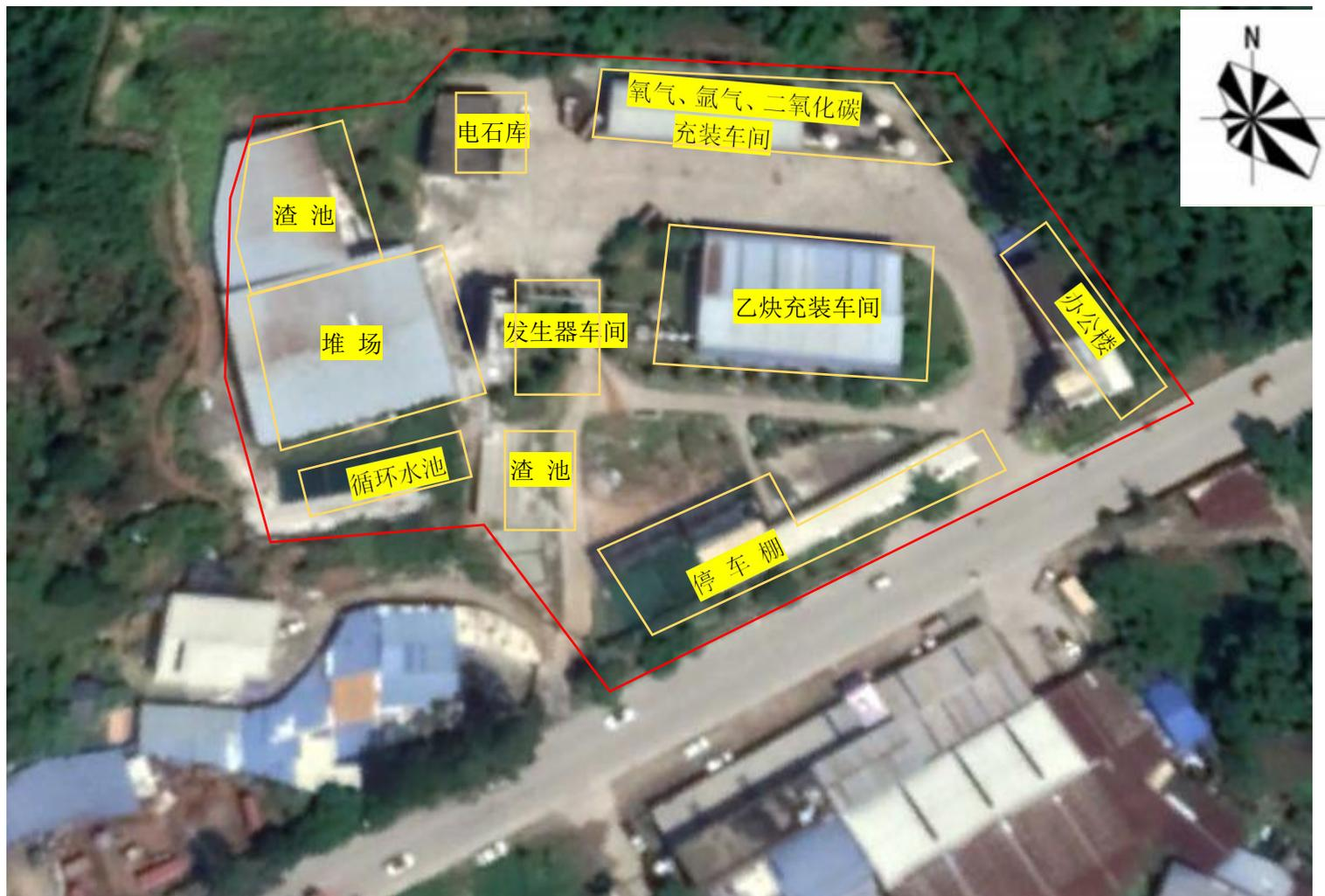
图 4.1-1 总平面布置图（已建部分）
